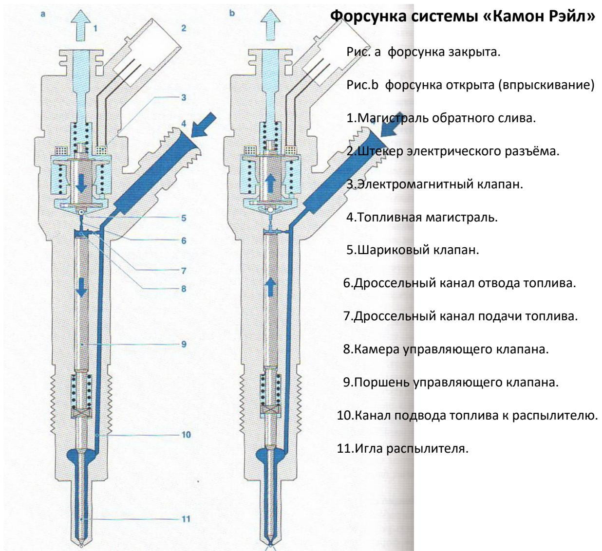
Наиболее подверженные кавитационной коррозии элементы форсунки шариковый клапан (5) и его седло, игла распылителя (11) и её седло. Фотографии, демонстрирующие износ представлены в разделе.
